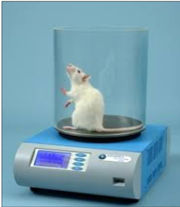
تصویر ۱۹- آزمون حس گرما: حیوان در محفظه شفاف روی صفحه داغ قرار گرفته و دمای صفحه بتدریج تا ۵۲ درجه سانتی‌گراد افزایش می‌یابد. مدت زمان قطع حرارت در صورت عدم پاسخ ۳۰ ثانیه است (۸۸-۹۰).
