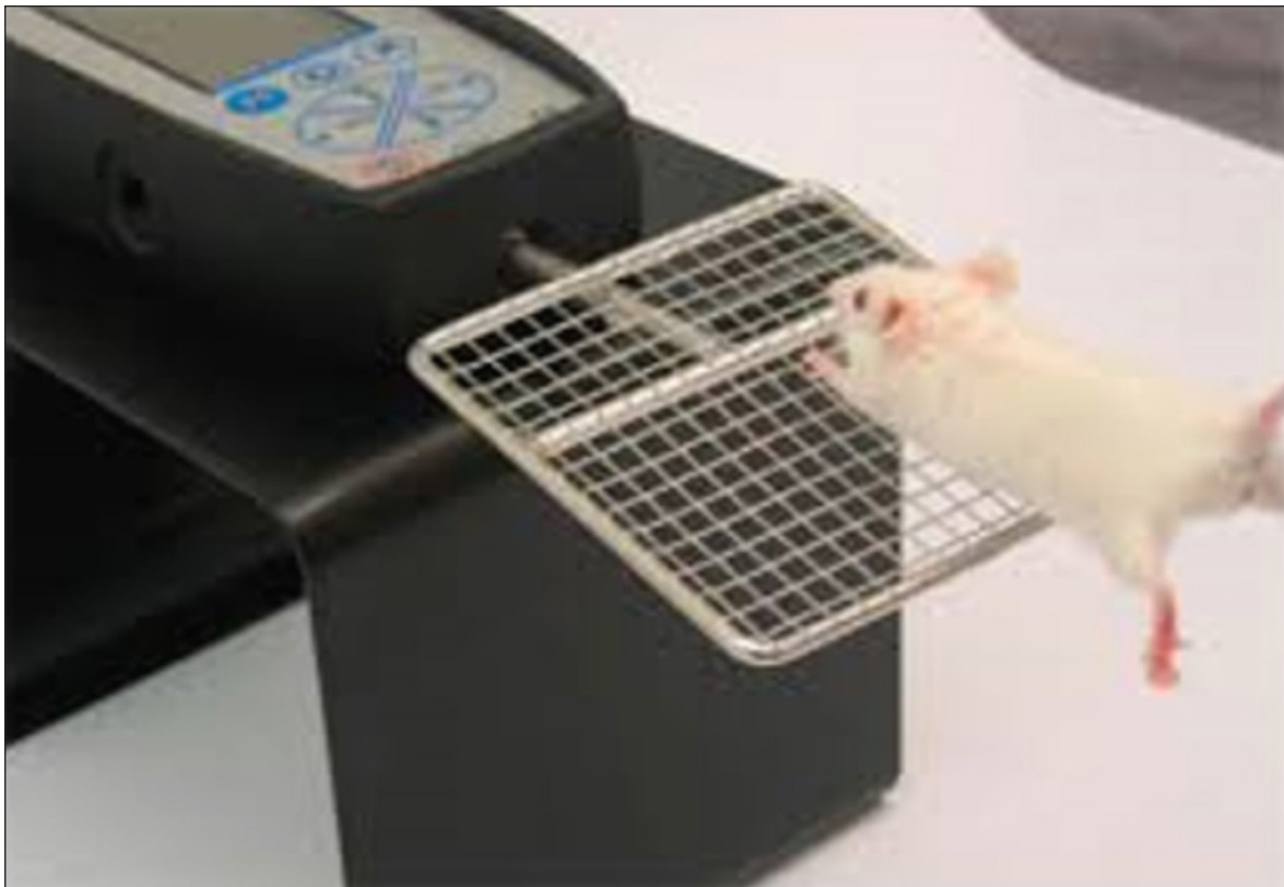
تصویر ۸- آزمون قدرت عضلات اندام قدامی و خلفی: این ابزار شامل یک شبکه فلزی است که به یک ترانس دیوسر دیجیتالی نیرو متصل می‌شود. مد دستگاه روی T-PK گذاشته شده روی صفر تنظیم می‌شود. موش صحرایی به طور موازی با شبکه قرار گرفته به آرامی از ناحیه دم کشیده می‌شود و پیک‌های مقاومتی حیوان روی صفحه نمایش توسط فرد ثبت می‌گردد (۴۷-۴۶).
