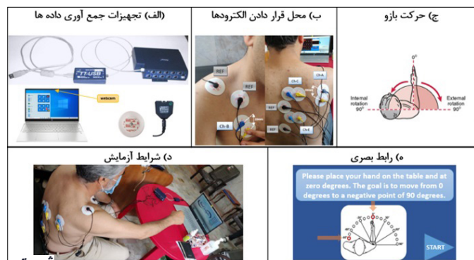
تصویر ۲- الف) تجهیزات جمع‌آوری داده‌ها (ب) محل قرار دادن الکترودها در عضلات مورد نظر (ج) حرکت بازو (د) شرایط اولیه شرکت‌کنندگان در آزمایش (ه) رابط بصری طراحی شده برای همگام‌سازی.
